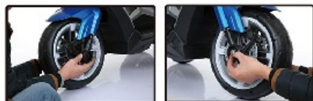
14. Namestite dekorativni deo 15. Namestite sajbrne i maticu
