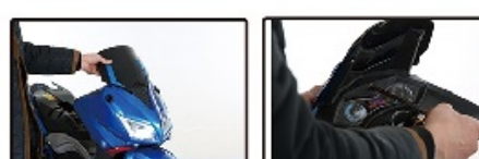
18. Namestite vetrubran 19. Ucvrstite ga uz pomoć srafova
