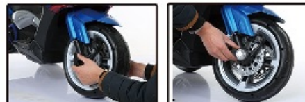
16. Stegnite maticu uz pomoć alata 17. Namestite dekorativne poklopce
