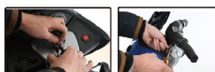
20. Namestite guvernal i povežite konektore 21. Zatim ucvrstite guvernal pomoću srala i maticu
